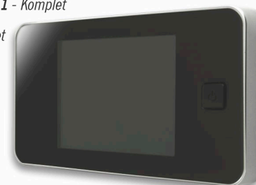
Äußere Dimension des Türspions/ outer dimension of the spyhole Ø32mm Einbau ausführbar in die Türfüllungen 38-110mm stark/ installation possible in the panels 38-110mm thick Dimension des Bildschirms/ screen dimension 125x68mm - 3.2" Blickwinkel/ angle of view 105°
